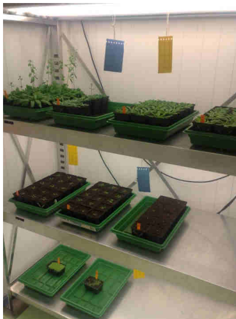
Figure 9. Chambre de culture thermo- et hygro-régulée du matériel végétal (phytotron).
