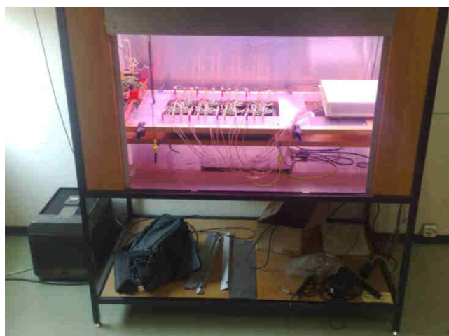
Figure 12. Cage de Faraday comprenant une enceinte à 7 tubes fluorescents (Sylvania Luxline Plus 18 W, non visible sur la photographie) et une enceinte de mesure, où sont installées les plantes mesurées. Ces deux enceintes sont isolées par une plaque de Plexiglas™.
